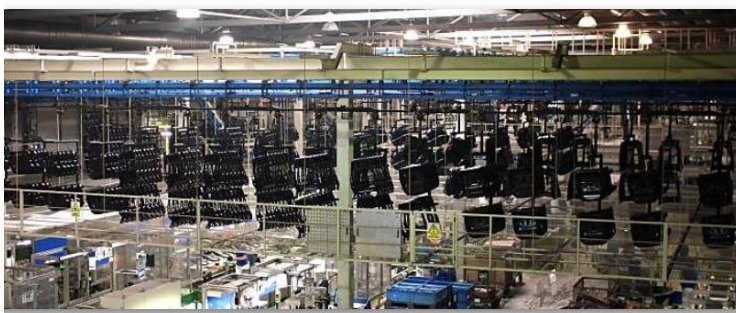
Rys. 7. Proces zautomatyzowanego lakierowania [9]
