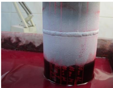
Rys. 8. Badanie penetracyjne złącza spawanego – wywołanie
