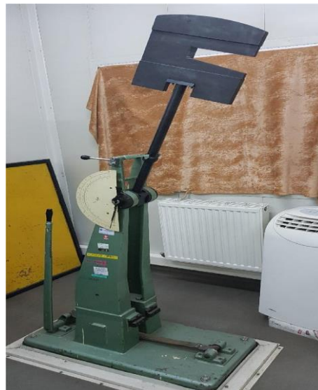
Rys. 5. Młot Sharpiego do próby udarności
