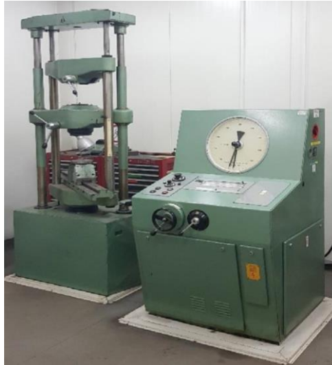
Rys. 4. Maszyna wytrzymałościowa do przeprowadzania próby zginania i rozciągania
