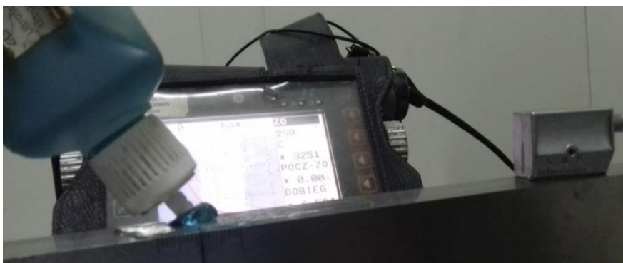
Rys. 2. Nanoszenie środka sprzęgającego na próbkę
