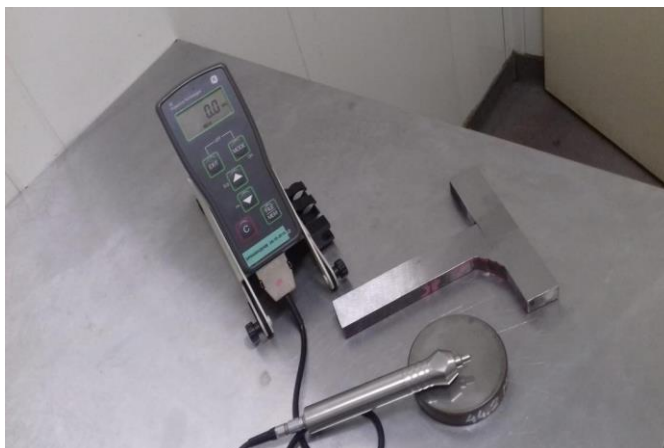
Rys. 6. Twardościomierz przenośny wraz z próbką badaną i próbką wzorcową
