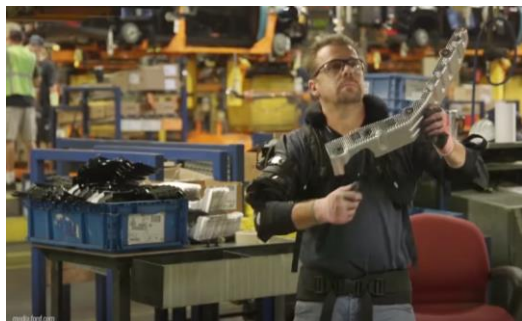
Rys. 3.6. Wykorzystanie egzoszkieletów EksoBionics w fabryce Forda w Dearborn [8]
