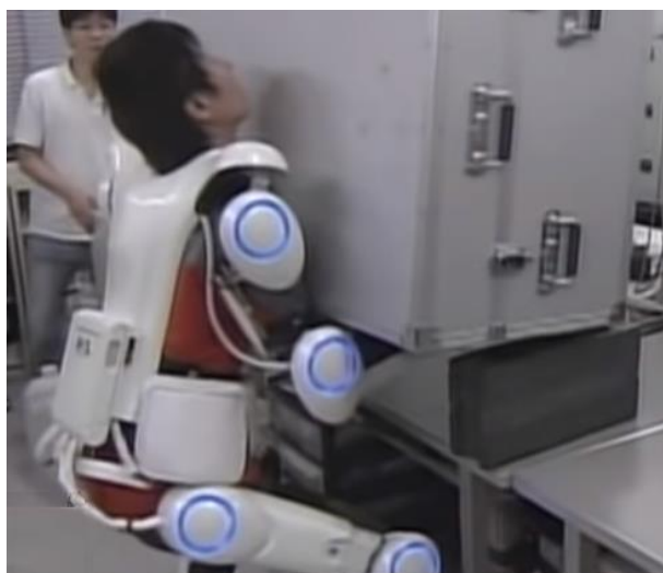
Rys. 3.5. Podnoszenie dużych ciężarów przy pomocy egzoszkieletów [8]
