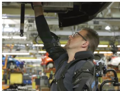
Rys. 3.6. Wykorzystanie egzoszkieletów EksoBionics w fabryce Forda w Dearborn [8]
