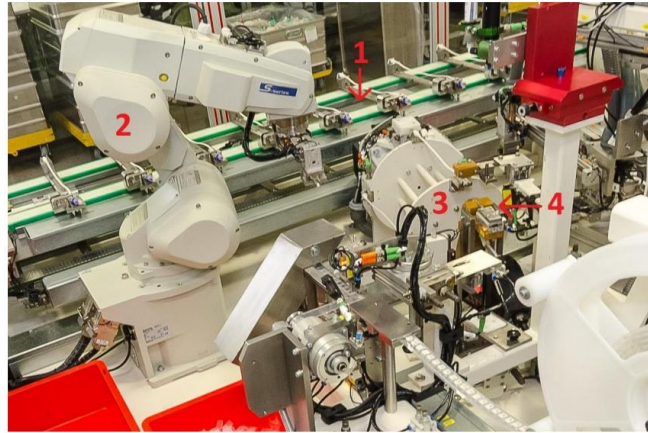
Rys. 4. Jednostka produkcyjna numer 2 ( 1 – taśma transportowa, 2 – robot produkcyjny, 3 – tester elektryczny, 4 – fragment stacji lutowniczej)
