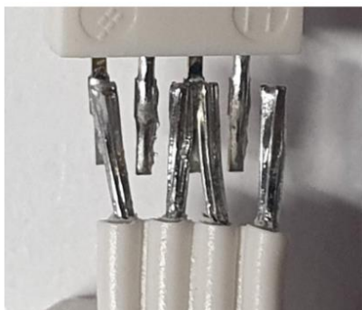
Rys. 16. Nieprzylutowany pin pomiędzy przewodem a sensorem
