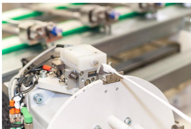
Rys. 19. Tester elektryczny w automacie Combitrans
