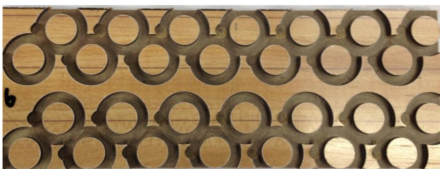
Rys. 11 Płytki wykonane przez frez MS200M d6.0c
