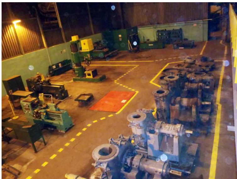
Rys. 8. Warsztat mechaniczny naprawy pomp i obróbki skrawaniem KGHM Zanam, po wdrożeniu 5S / TPM
