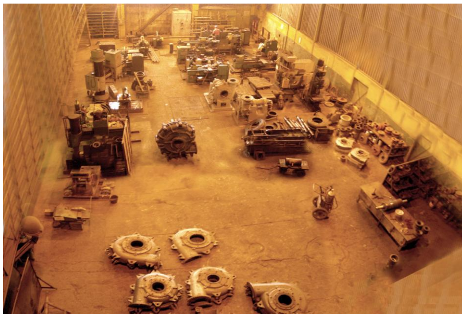
Rys. 7. Warsztat mechaniczny naprawy pomp i obróbki skrawaniem - KGHM Zanam, przed wdrożeniem TPM
