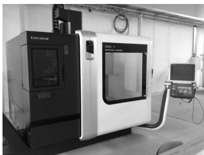
Rys. 1. Frezarka CNC 5-osiowa typu DMU70 firmy DMG Mori Deckel Maho z układem sterownia SINUMERIK 840D
