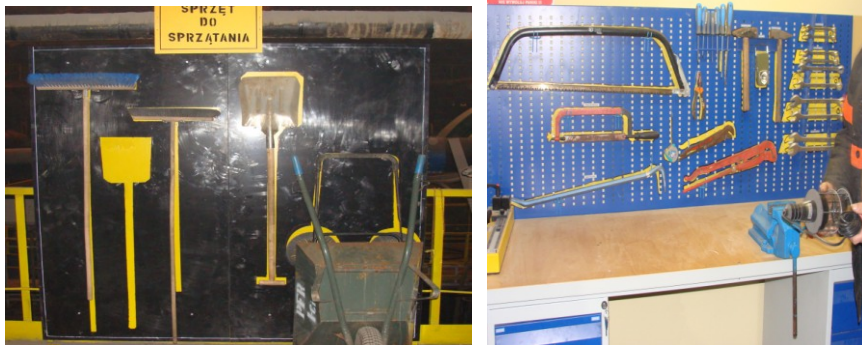
Rys. 1. Sprzęt pomocniczy dla pracowników produkcyjnych w ZWR, tablica cieni.
