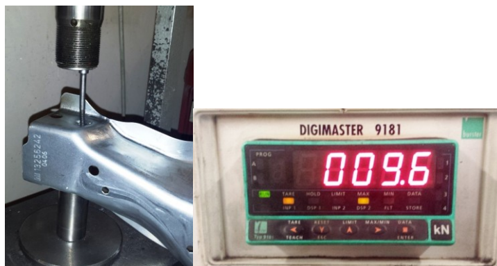
Rys.5. Kontrola siły wyciskania na prasce hydraulicznej i odczyt osiągniętej siły [5]
