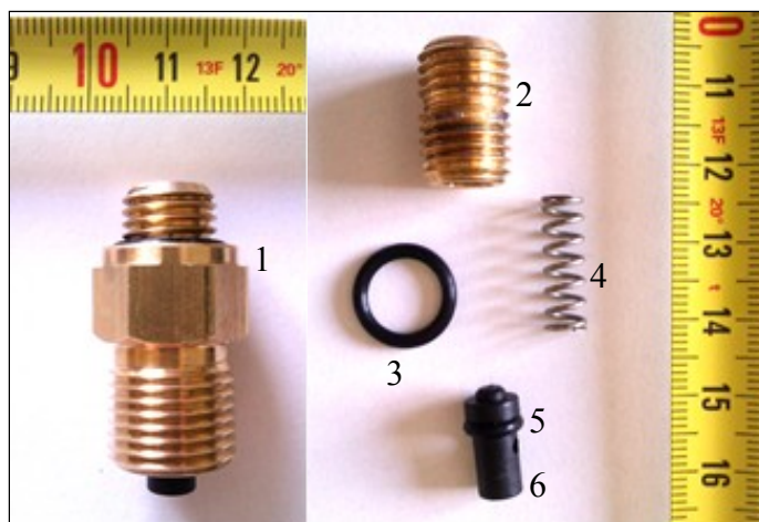
Rys. 3. Budowa zaworu kontrolnego: a – złożony zawór HPh M16/M12; b – elementy wchodzące w skład zaworu; gdzie: 1 – korpus zaworu, materiał: mosiądz, 2 – wkrętka zaworu, materiał: mosiądz, 3 – o-ring wkrętki, materiał: NBR, 4 – sprężyna, materiał: stal sprężysta
