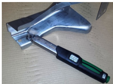
Rys.4. Kontrola momentu skręcającego nakrętki M6 za pomocą klucza dynamometrycznego [opracowanie własne]
