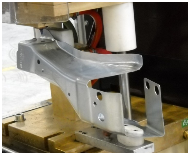
Rys.3. Element 13 256 240 na przyrządzie do zgrzewania garbowego nakrętek [5]
