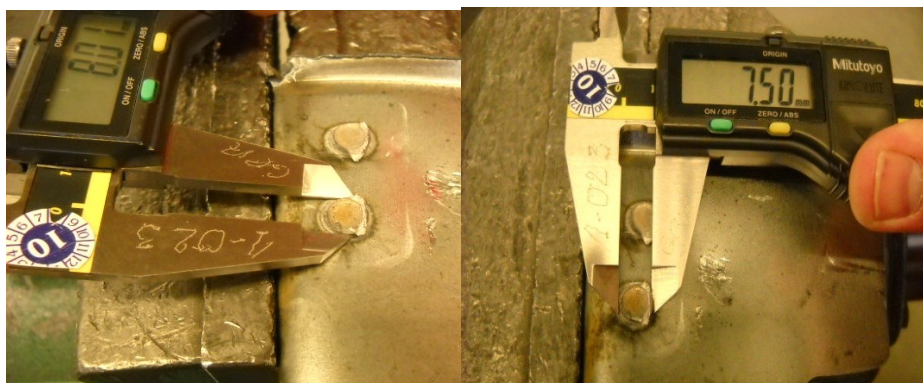
Rys.10. Pomiar średnic zgrzeiny zerwanych próbek[5]
