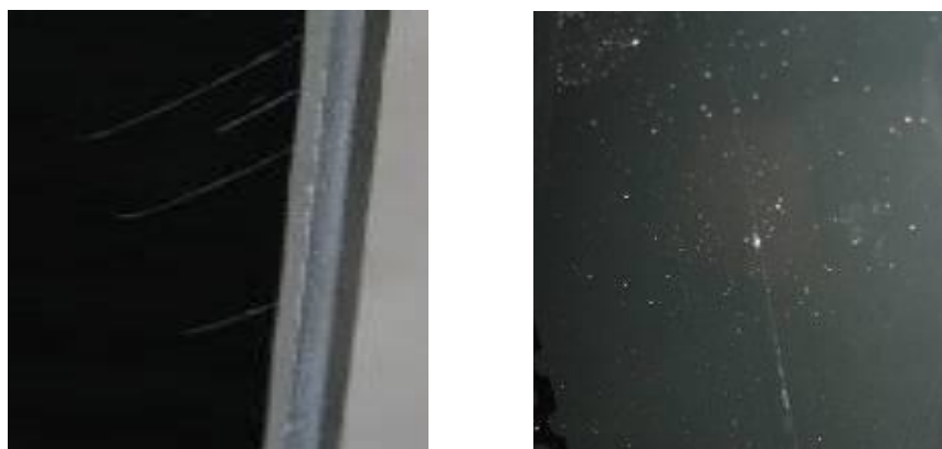
Rys. 3. Wady powierzchni – rysy włosowate [Kmera M., 2013]
