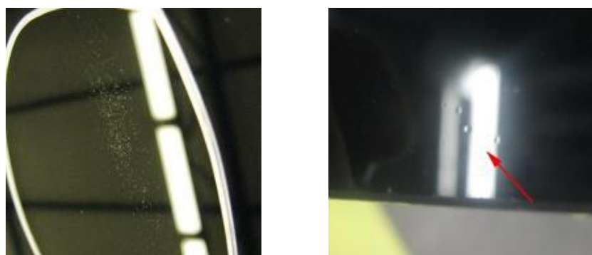
Rys. 4. Wady powierzchni – wyciski [Kmera M, 2013]
