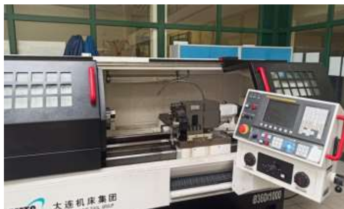
Rys. 1. Tokarka CNC typu CKE6136i firmy DMTG.
