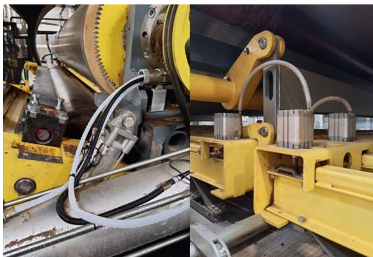
Rys. 7. Podgrzewacz (z lewej) i stół grzewczy (z prawej) [fot. T. Modrzyk].
