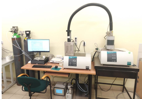
Rys. 1. Stanowisko badawcze do analizy termicznej DSC i TGA
