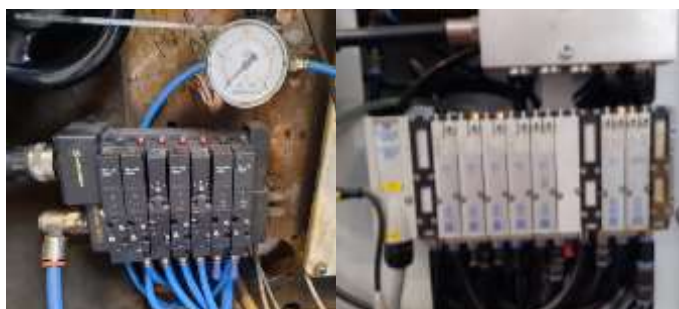
Rys. 9. Wyspy elektrozaworowe [fot. T. Modrzyk].
