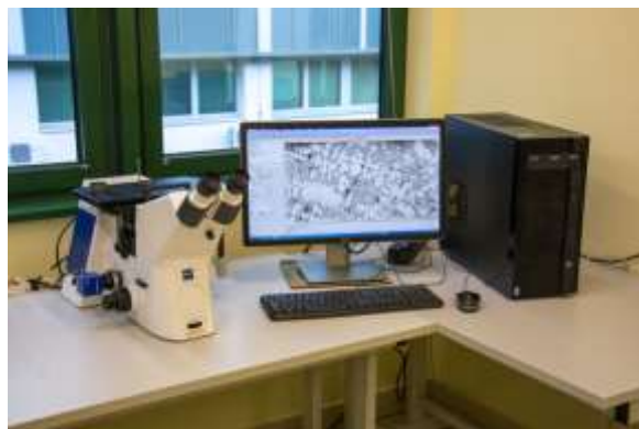
Rys. 1. Mikroskop metalograficzny Zeiss Axio Observer A1
