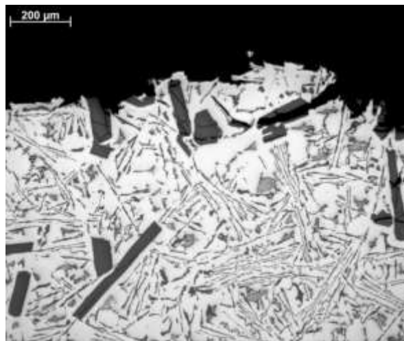
Rys. 10. Obraz profilu przelomu siluminu AlSi21CuNi po modyfikacji dodatkiem 0,12% CuP12
