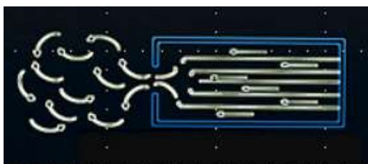
Rys. 11. Turbulencja wyciekającego powietrza [12].
