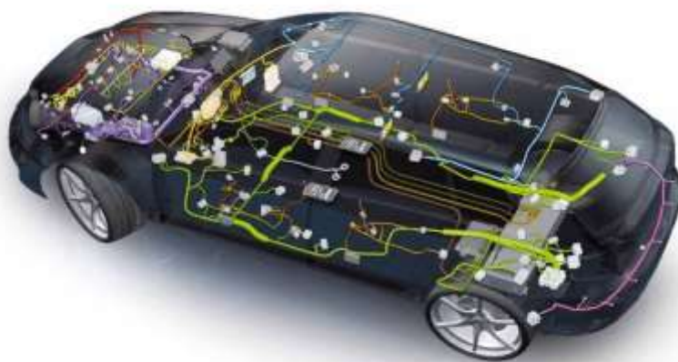
Rys 1. Architektura elektryczno-elektroniczna współczesnego samochodu osobowego [10]
