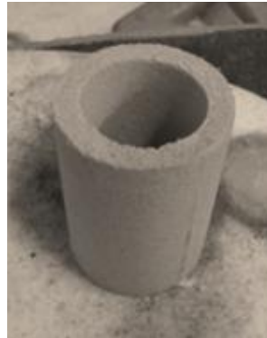
Rys. 2. Zdjęcie próbника z masy skorupowej [5]
