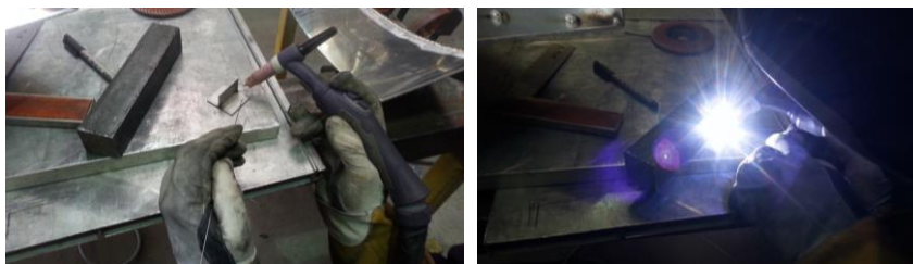
Rys. 2. Przygotowanie próbek: (a) blachy szczipione bezpośrednio przed spawaniem, (b) spawanie próbek
