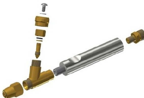
Rys. 12. Wynikowa konstrukcja palnika gazowego
