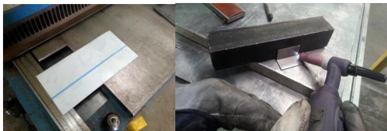
Rys. 1. Przygotowanie próbek: (a) cięcie blach, (b) szepianie blach
