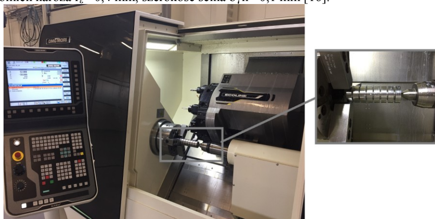
Rys. 1. Tokarka CNC typu CTX 510 firmy DMG MORI SEIKI wraz z próbką
