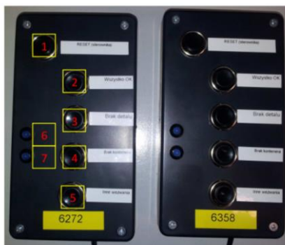
Rysunek 7. Interfejs urządzenia typu KLIENT1 montowanego na gniazdach produkcyjnych (1 – restart urządzenia, 2 – wysłanie do serwera statusu: Wszystko OK, 3 – wysłanie do serwera statusu: Brak detalu, 4 – wysłanie do serwera statusu: Brak kontenera, 5 – wysłanie do serwera statusu: Inne wezwania, 6 i 7 – diody sygnalizacyjne informujące pracownika o stanie pracy urządzenia)
