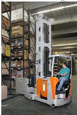
Rysunek 1. Wózek transportowy o małym korytarzu roboczym [5]
