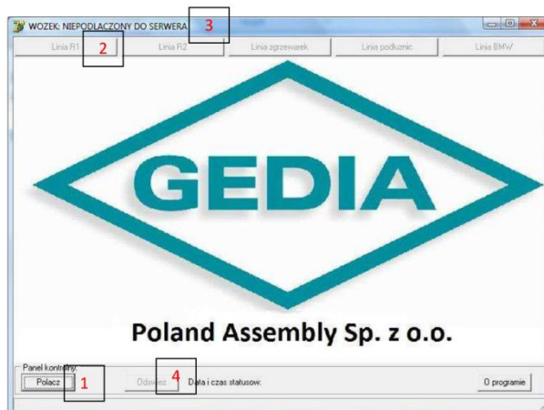
Rysunek 9. Zrzut ekranu z aplikacji typu KLIENT2 umieszczanej w terminalu na wózku transportowym (1 – przycisk połączenia z SERWER-em, 2 – przyciski wyboru odpowiednich linii produkcyjnych, 3 – belka informacyjna informująca o stanie pracy aplikacji, 4 – przycisk pobrania statusów wszystkich gniazd produkcyjnych z SERWERA)
