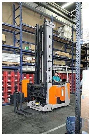
Rysunek 1. Wózek transportowy o małym korytarzu roboczym [5]
