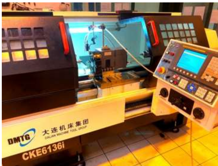
Rys. 1. Tokarka CNC typu CKE6136i firmy DMTG z systemem sterowania Fanuc.
