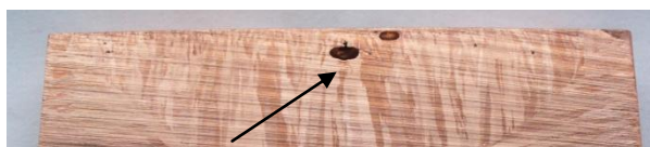
Rys. 1.16. Pustki pogazowe-przekrój poprzeczny pasma
