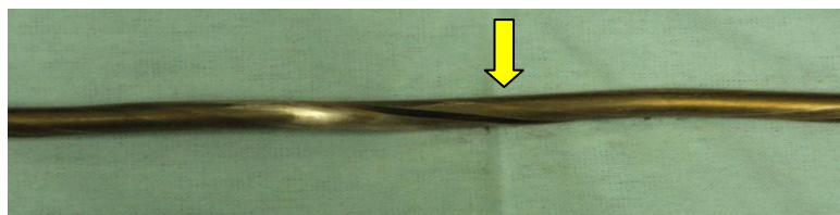
Rys. 1.10. Wady walcówki - pęknięcia
