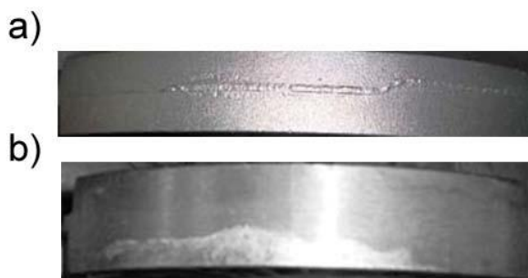
Rys. 2.5. Wygląd powierzchni detalu: a) przed szlifowaniem, b) po szlifowaniu
