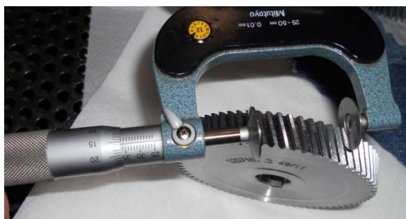
Rys. 5.3. Pomiar szerokości zębów
