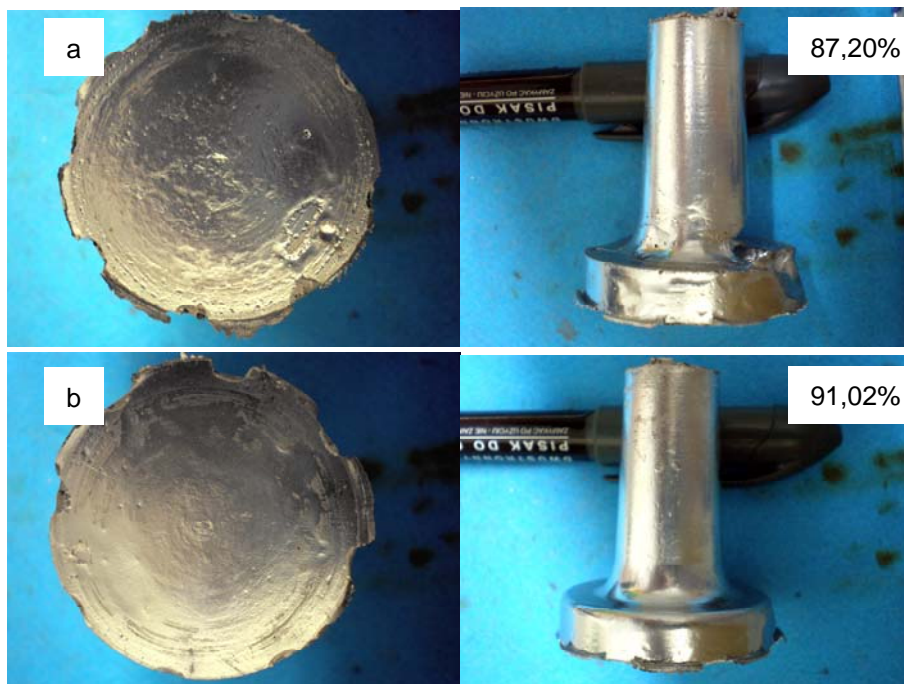
Rys. 7.6. Próbkki ze stopu z grupy AlSi10Mg dla formy o temperaturze: a) 180°C; b) 250°C
