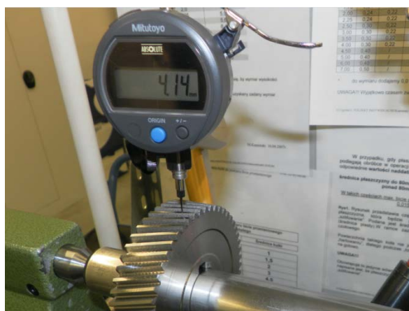
Rys. 5.4. Pomiar wysokości zębów
