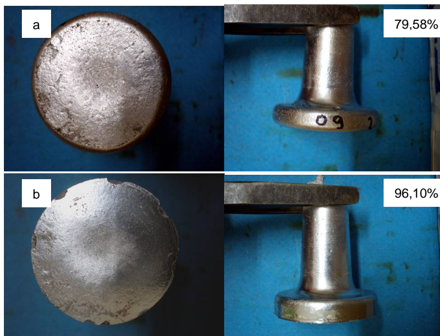
Rys. 7.3. Próbkki ze stopu z grupy AlSi dla formy o temperaturze: a) 180°C; b) 250°C
