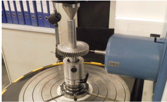
Rys. 5.5. Pomiar bicia oraz linii zarysu bocznego
