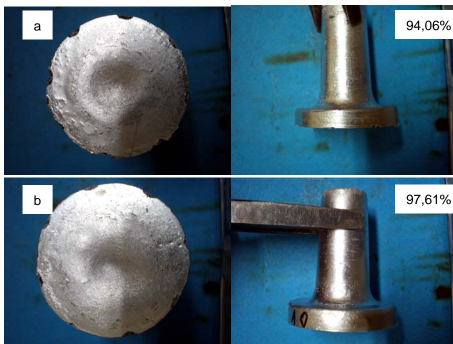
Rys. 7.4. Próbkki ze stopu z grupy AlSiMgTi dla formy o temperaturze: a) 180°C; b) 250°C
