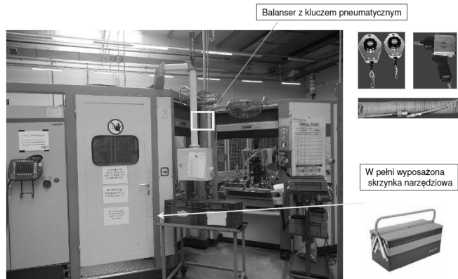
Rys. 10. Doposażenie maszyny oraz zmiany rozmieszczenia narzędzi
