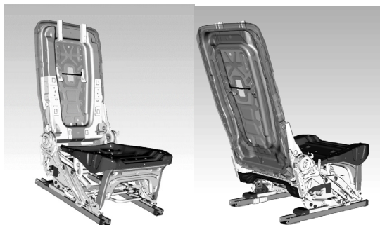
Rys. 3. Widok stelażu siedziska, przeznaczonego dla drugiego rzędu siedzeń w samochodzie VW Sharan (II)
