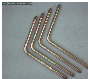
Rys. 2. Sztyfty z kątem zagięcia 100°; średnica drutu 1,51 mm
