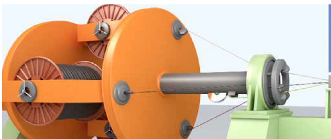
Rys. 7. Proces skręcania ośrodków [4]
