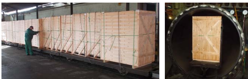
Rys. 3. Wyroby ustawione na platformie przed wjazdem do autoklawu nr 1 (z lewej) oraz po umieszczeniu w autoklawie (z prawej)
