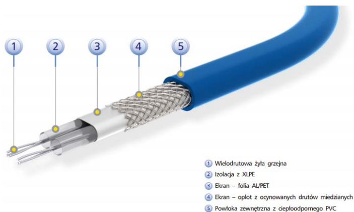
Rys. 6. Schemat budowy kabla grzewczego
